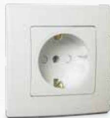
Розетка с заземлением и защитой от детей * 32001058 16 A, 250 V~ IEC 60884-1
