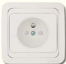
12053 Розетка UPS с защитой от детей Напряжение 250V Сила тока 16A Степень защиты IP40
